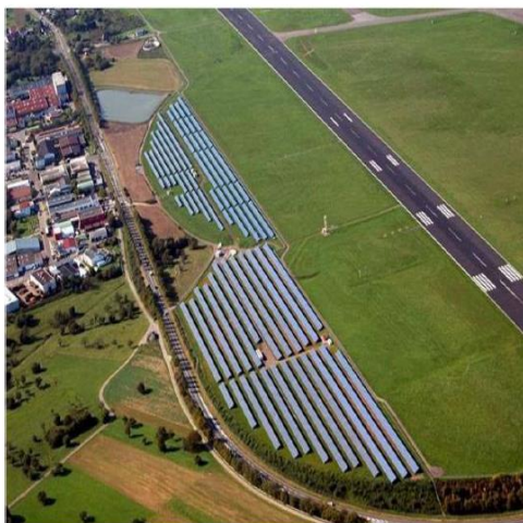
Esempi di impianti fotovoltaici in ambito aeroportuale. La disposizione dei moduli fotovoltaici in prossimità delle piste di atterraggio/decollo non rappresenta un rischio per la sicurezza
